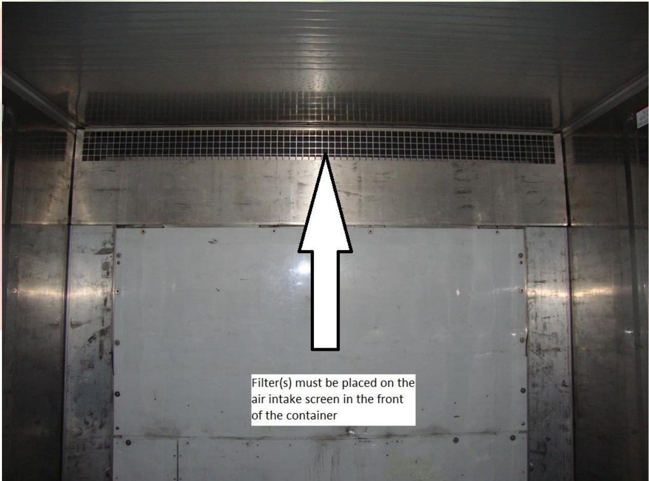
2. Instalar los Filtros BXT100 en la rejilla de retorno del aire es una operación sencilla y rápida. El filtro se ata manualmente a la parrilla con 2 fijaciones proporcionadas por BioXTEND tal y como se muestra en la siguiente foto
