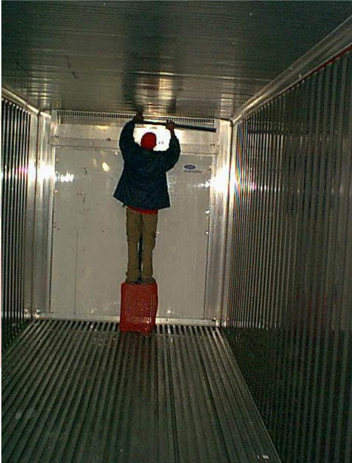
4. Aquí vemos el contenedor con dos Filtros instalados, listo para cargar la mercancía: el Filtro BXT100 de BioXTEND purifica el aire del contenedor mientras ese regresa hacia el aparato de frío para refrigerarse. El proceso es constante manteniendo el aire libre de etileno, bacteria y esporas de hongos durante la totalidad del viaje
